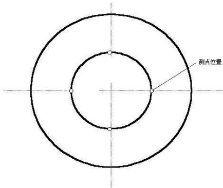
图 4：圆形风口测点布置
