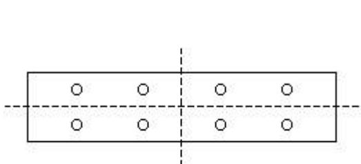
图 3：条缝形风口测点布置
